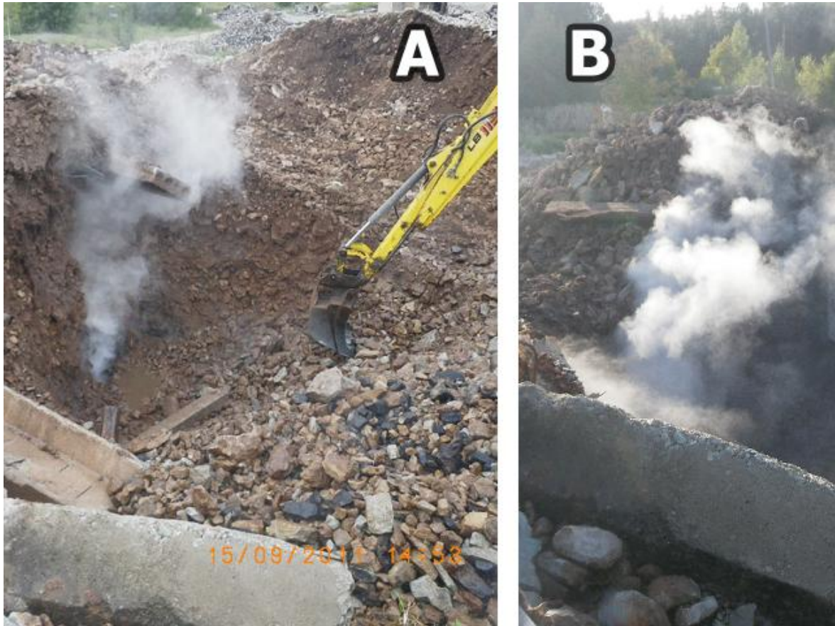
Joonis 3. A: Põleva kivimi väljatõstmine ekskavaatoriga. B: Põlevkivi aheraine isesüttimine (autori joonis)
