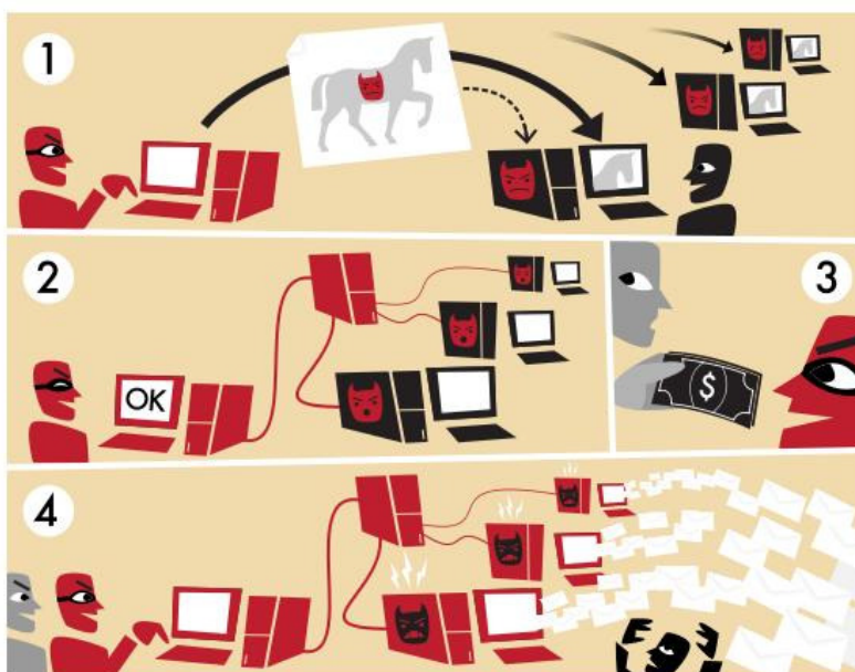
Joonis 5. Botneti tööpõhimõte (How...02.04.2012)
