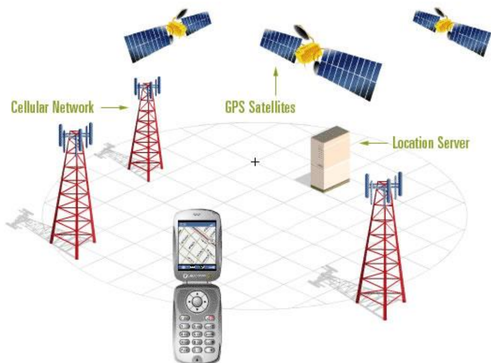
Joonis 1. A-GPS-i signaalide struktuur (Allikas: Assisted...2009)
