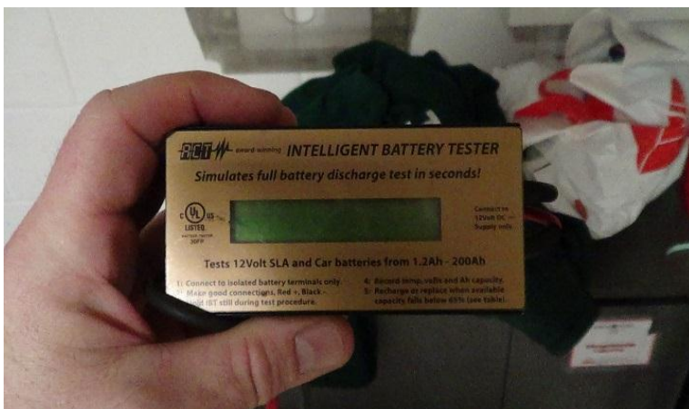
Joonis 3. Intelligent Battery Tester akude mahtuvuse hindamiseks (autori foto)
