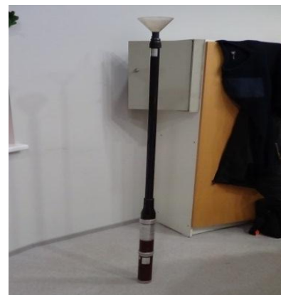
Joonis 2. Suitsupüssi Detector tester TSE A100 (autori joonis)
