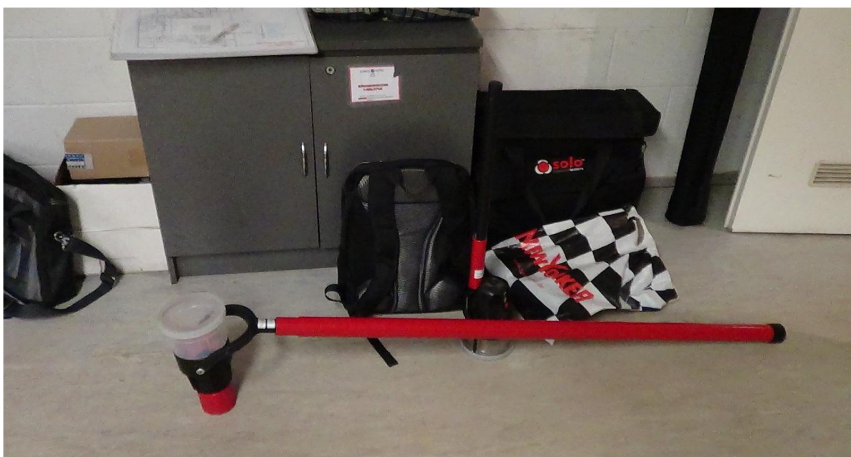
Joonis 4. Horisontaalselt põrandal suitsutester SOLO (autori foto)
