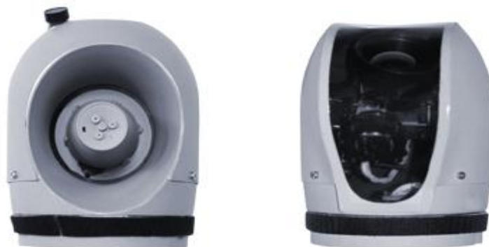
Joonis 19. Mikro kopter-drooni seadmed: Тревога-1(teavitusmoodul koos kaameraga) ja optilise ja termokaamera moodul (Droonide...16.01.2014)
