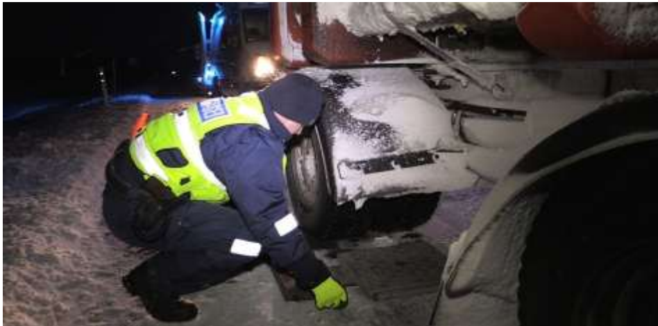
Foto 1. Evocar 2000 tüüpi kaalude paigaldamine veoki rataste alla. (Kuulutaja, 2015)
