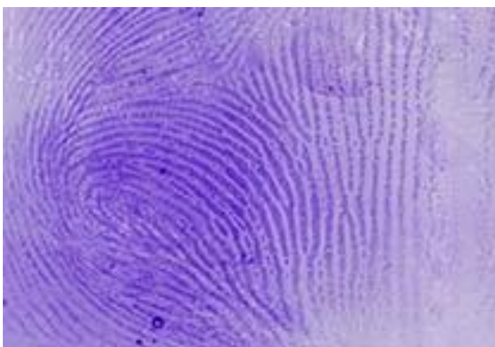
Joonis 15. GV meetodikaga esiletoodud sõrmejalg teibil (BVDA, 2023g)
