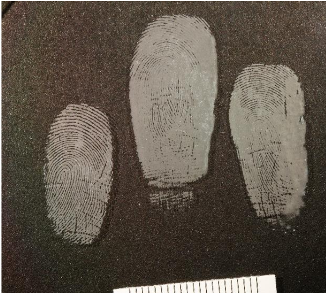
Joonis 20. Tsüanoakrülaadmetoodikaga esile toodud sõrmejäljed Petri tassil (autori koostatud)
