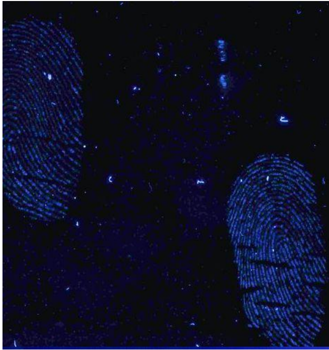
Joonis 5. PC UV meetoodikaga esiletoodud sõrmejäljed musta keraamilise plaadi peal. Jäljed fluoretseeruvad UV valguses (Foster + Freeman, 2023)
