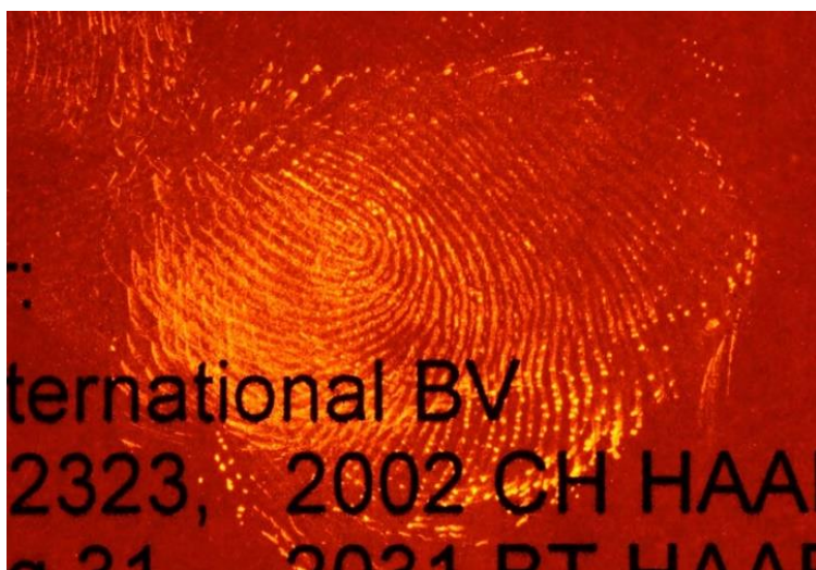
Joonis 13. DFO meetodikaga esiletoodud sõrmejalg kasutades valgusallikat 530 nm ja OG590 filtrit, Foster & Freeman (BVDA, 2023e)
