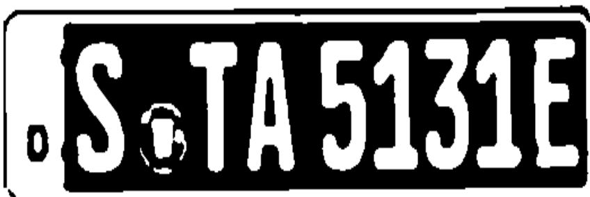
Joonis 5. Lisatakse Otsu's Binarization töötlus, et eristada selgelt numbrid ja tähed (Poorani jt, 2020, p. 135)
