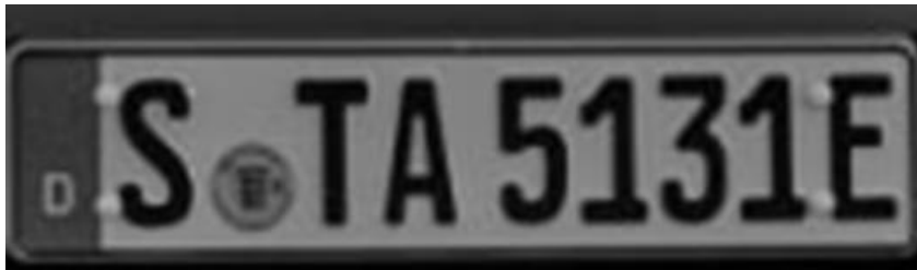
Joonis 4. Lisatakse Gaussian Smoothing töötlus, et eemaldada pildilt müra (Poorani jt, 2020, p. 134)
