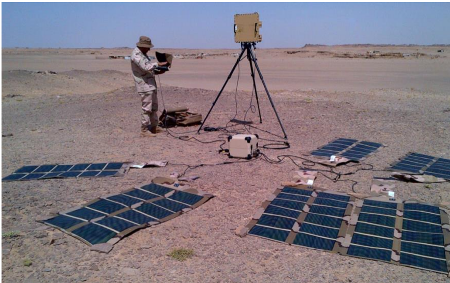
Joonis 2. Ametnik päikeseenergiaal töötavat maismaapinna valvamise radarit kasutamas (Blighter Surveillance Systems, 2020)
