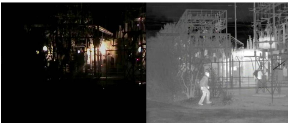
Joonis 9. Vaade pimedale alale kasutades tavalist ja termograafilist kaamerat. (Distelzweig, et al. , 2018)
