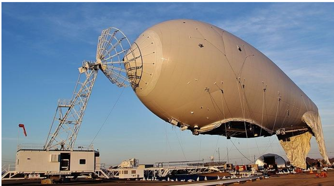
Joonis 6. TARS – maapinnale lõastatud aerostaadi radarsüsteem (Everything RF, 2020)
