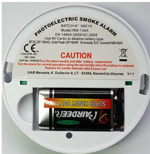
Joonis 6. Autonoomse tulekahjusignalisatsioonanduri tagakülg olulise informatsiooniga. Kõik autonoomsed suitsuandurid peavad vastama Euroopa standardile EN 14604:2005.
