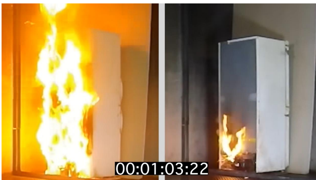
Joonis 12. Külmkapi leegilevimise võrdlus plastikust ja metallist tagaseina vahel minut hiljem ( London Fire Brigade, 2017, aeg 63 sek)
