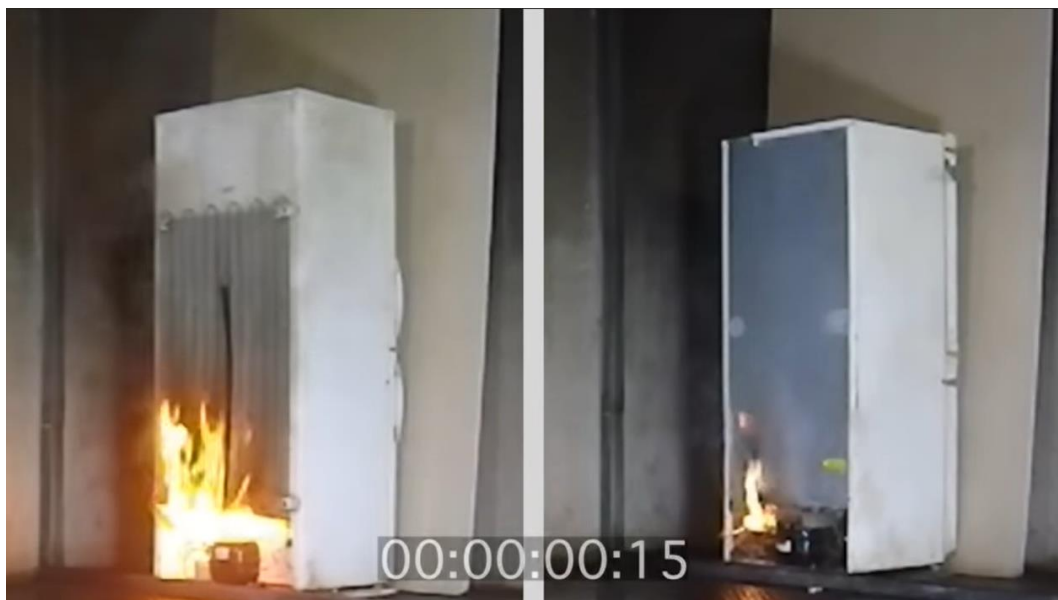
Joonis 10. Külmkapi leegilevimise võrdlus plastikust ja metallist tagaseina vahel algfaas (London Fire Brigade, 2017, aeg 0 sek)
