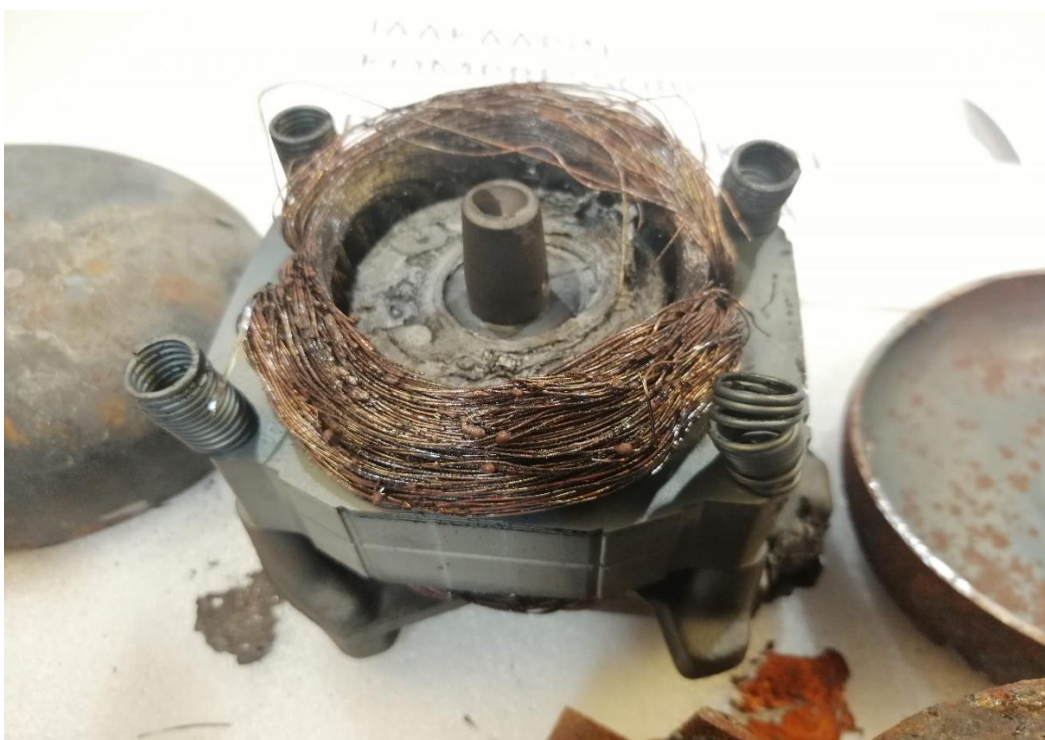
Joonis 2. Külmkapi kompressori voolu ülekoormuse kahjustused (Luht-Kallas, 2019)
