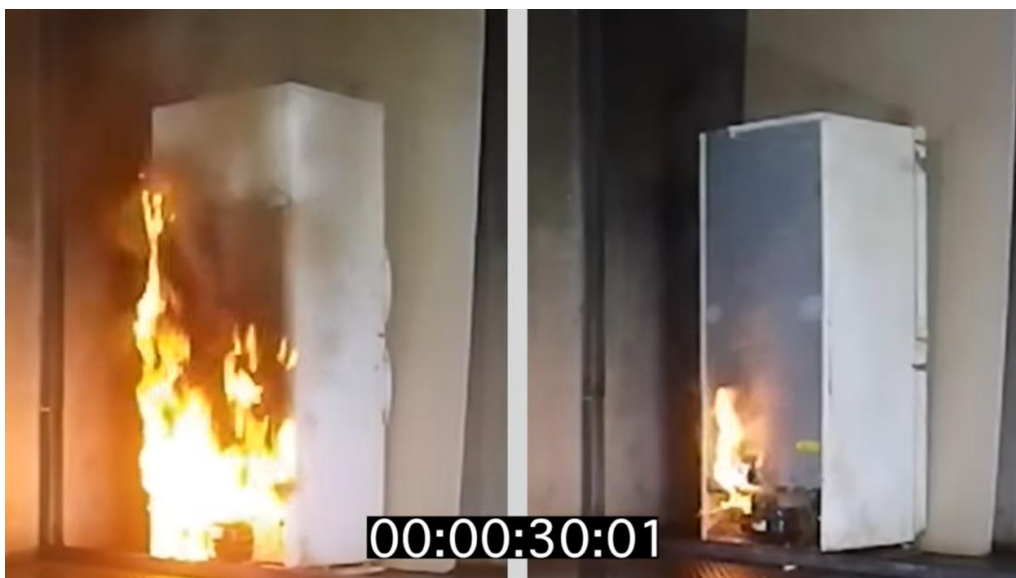
Joonis 11. Külmkapi leegilevimise võrdlus plastikust ja metallist tagaseina vahel pool minutit hiljem ( London Fire Brigade, 2017, aeg 30 sek)
