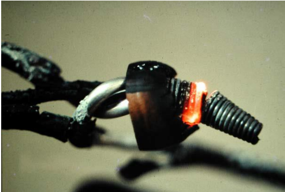
Joonis 5. Halvasti ja nõrgalt ühendatud juhtmete keeratav kiirühendus (Aronstein, 2011, p. 2)
