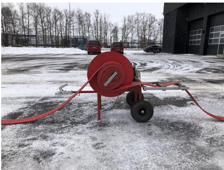
Joonis 11. Vooliku kerijaga 77 mm vooliku kerimine voolikurulli (autori koostatud)
