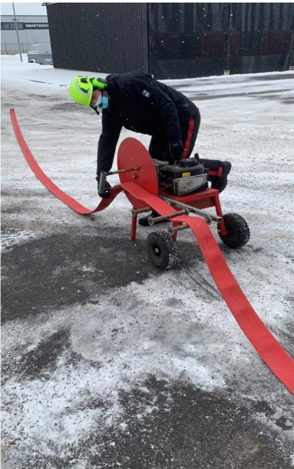
Joonis 13. Voolikurulli kerimine ühe päästjaga (autori koostatud)
