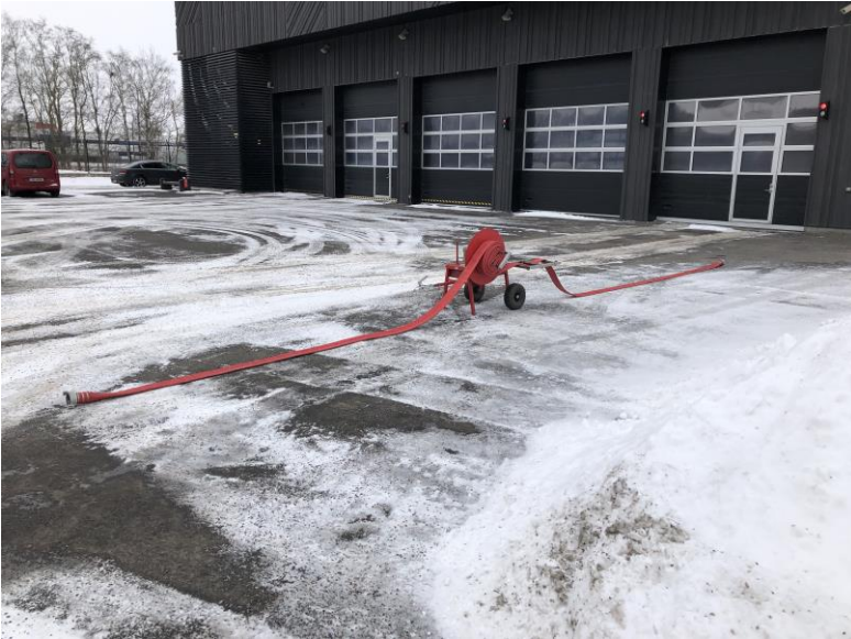
Joonis 12. 77 mm vooliku kerimine voolikurulli külj vaade (autori koostatud)
