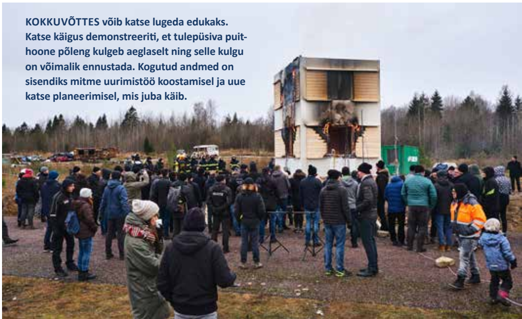
Tulekahju esimene jahtumisfaas, enne puidukihi delamineerumist ja uut lahvastust
