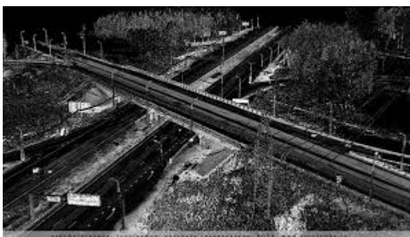
Joonis 6. Kolmas laserskaneerimise tüüp ehk mobiilne laserskaneerimine (Середович, 2013)
