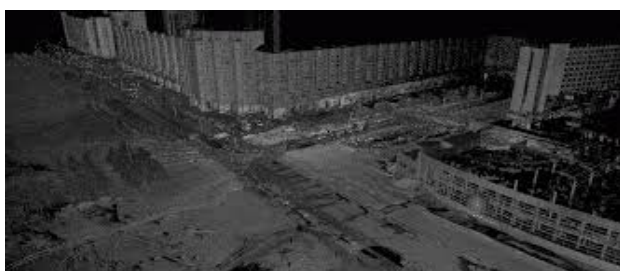
Joonis 4. On esimene laserskaneerimise tüüp ehk maapeale laserskaneerimine (Середович, 2013)
