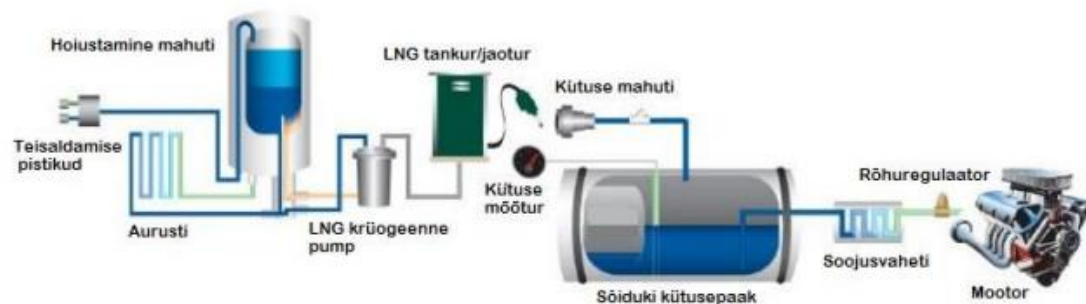
Joonis 4. Kontseptsioon LNG tanklast kuni mootorsõiduki mootorini (Trink & Oja, 2014)
