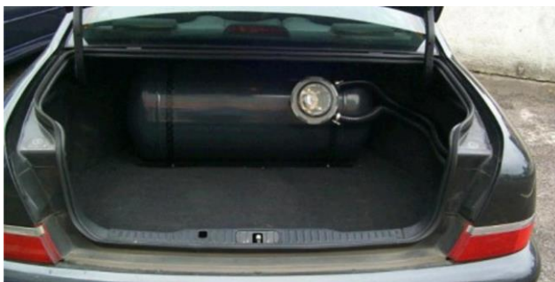
Joonis 7. Gaasiballooni paigutus pagasiruumis (Alborz Fallah, 2006)
