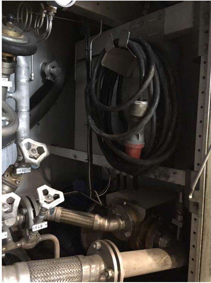
Joonis 15. Elme Messer Gaas AS tsisterni krüopump, mille ajamiks on elektrimootor. (autori pilt)
