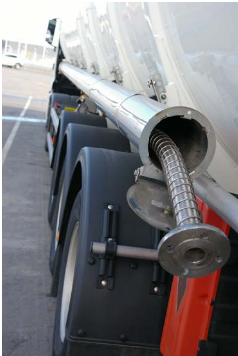
Joonis 14. AS Eesti Gaasi tsisterni lisavoolik. (autori pilt)
