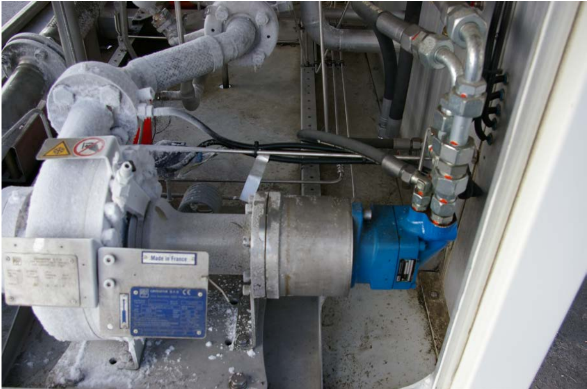
Joonis 11. AS Eesti Gaasi tsisterni krüopump ja seda käitav hüdraulikasüsteem. (autori pilt)
