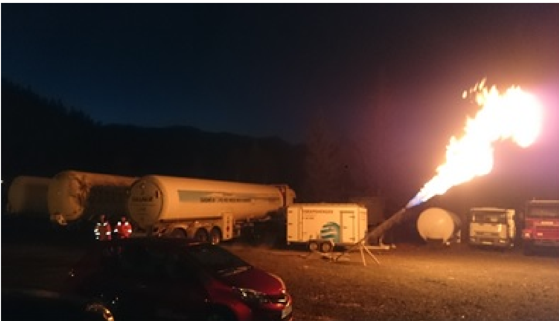
Joonis 10. LNG põleti. (Jefimov, 2018)
