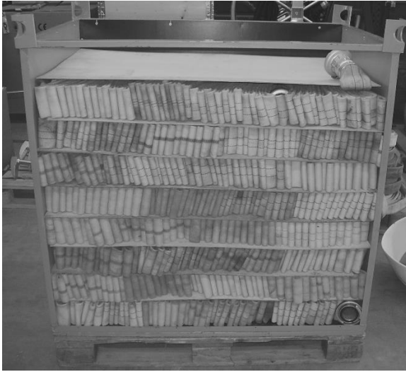
Joonis 5. Väike konteiner (tuletõrjevoolikud paigutatud servitilappamise meetodil). autori foto
