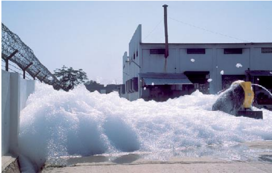
Joonis 1. Kõrgkordse vahuagregaadi moodustatud kõrgkordne ehk kergvaht 75
