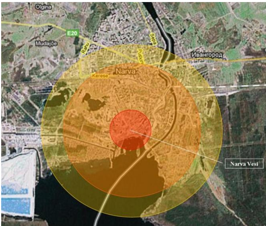
Joonis 10. Väljavoolanud kloori ohuala AS Narva Vesi territooriumil, Ida-Viru maakonna keemiaohtude määramine suurõnnetuse ohuga ettevõtete hindamistulemuste alusel, 2008. L. Sokolov
