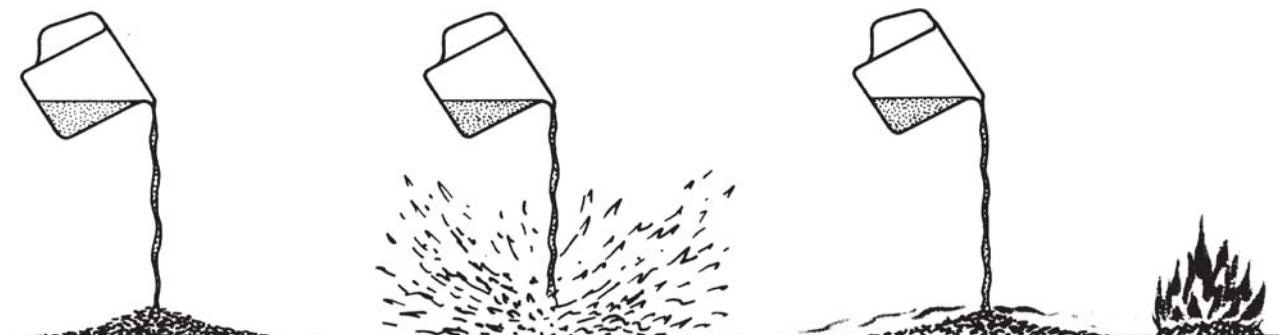
Joonis 3.1. Kahe aine segamine võib olla ohtlik mitmel viisil: võib eralduda mürgine gaas, segu võib plahvatada või süttida või keemilise reaktsiooni soojus võib põhjustada lähedalolevate materjalide isesüttimise.
