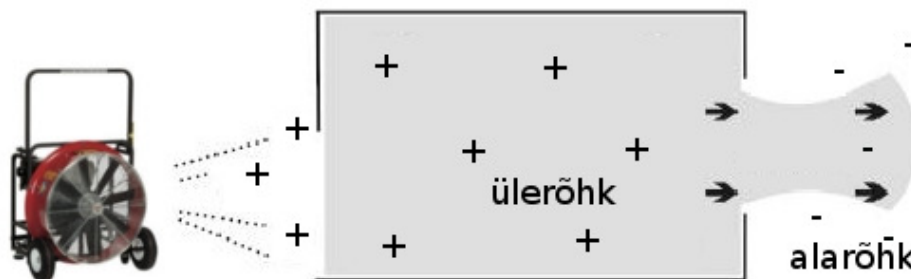
Joonis 1. Ülerõhuventilatsiooni üldpõhimõte (autor)
