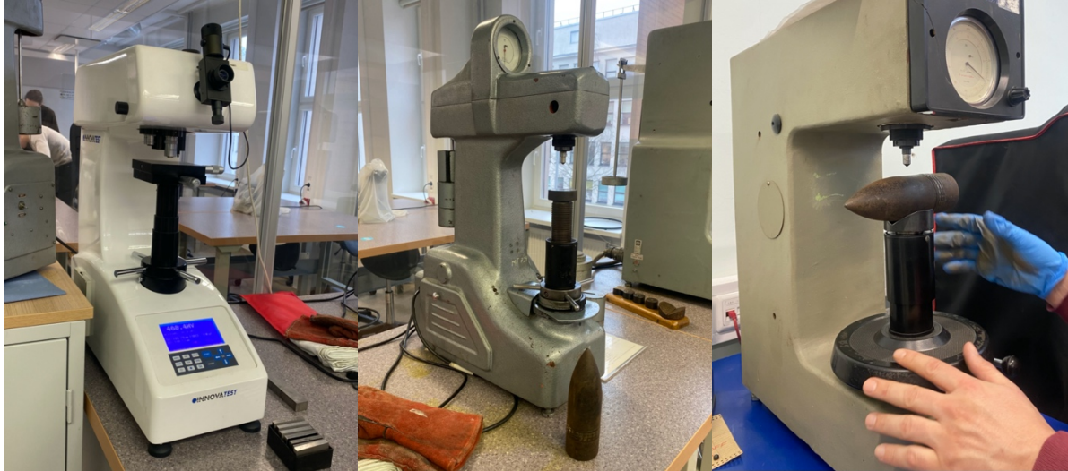
Joonis 10. Kolm kõvaduse mõõteseadet, vasakul Vickers ning keskel ja paremal Rockwell (Mitt, 2024)
