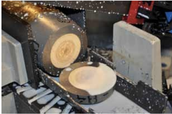
Joonis 5. Metallilõike-saag lahingumoona lõikamiseks (Bajić, et al. , 2020, p. 13)
