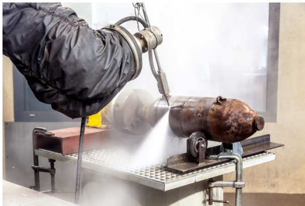
Joonis 4. Lahingumoon vesilõikuse tehnoloogia (Hammelman, 2023)
