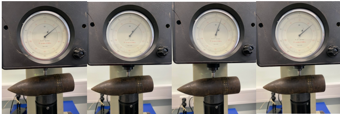
Joonis 11. Mürsu kõvaduse mõõtmine neljast erinevast kohast (Mitt, 2024)
