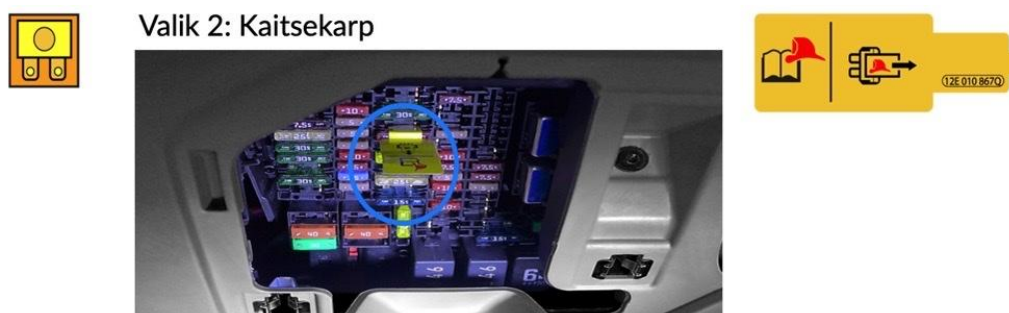
Joonis 10. Kõrgepinge väljalülitamine kaitsmekarbist (Trakmann, 2022)
