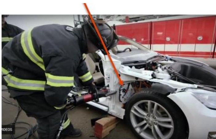
Joonis 14. Turvatala läbilõikamine (Trakmann, 2022)
