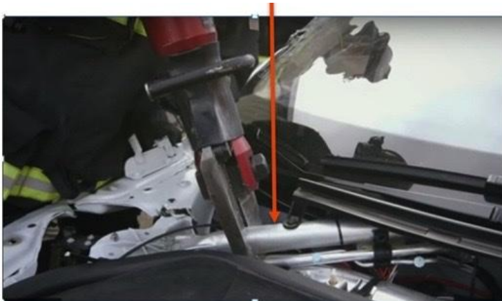
Joonis 14. Turvatala läbilõikamine (Trakmann, 2022)
