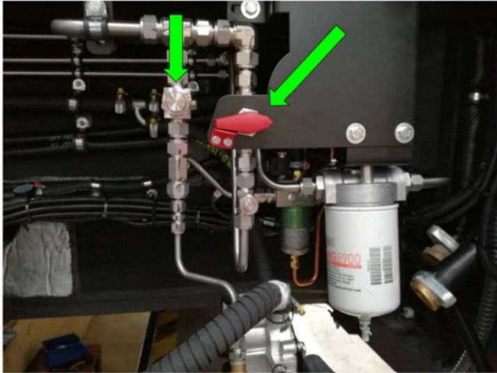
Joonis 6. Bussi mootoriruumis asuv kõrgsurve keraamiline gaasifilter ja gaasi torustikust väljalaske avariiventil (punane) (Solaris A Caf Group Company, 2020)
