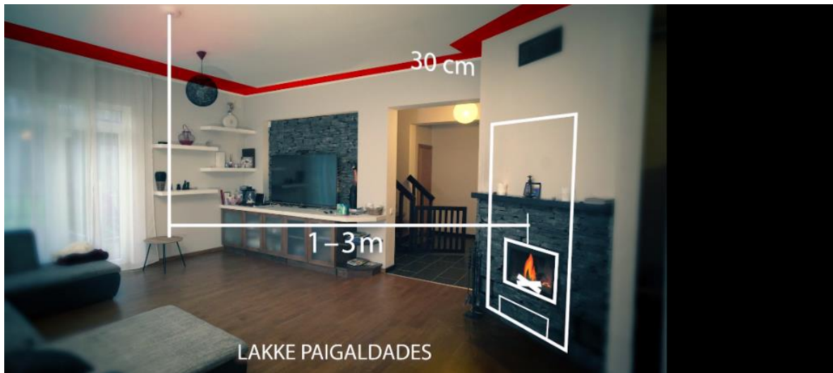
Pilt 3. "Vingugaasianduri paigaldamine" kuvatõmis videost (Päästeamet, 2019)
